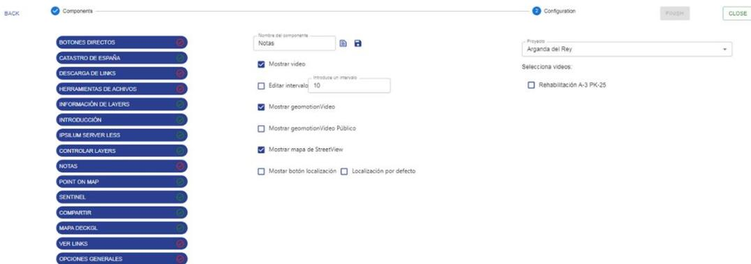
**POINT ON MAP:** esta herramienta permite, a través de seleccionar un punto en el mapa, que se abra una nueva ventana con una nube de puntos centrada en el lugar indicado. Configurada a través de la base de datos y conexión IPS.
